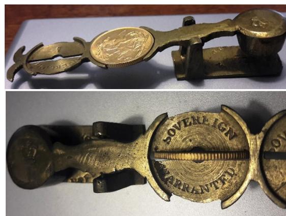
*Fig. 2 - Il braccio della bilancina è in equilibrio, indicando come il peso della moneta si mantenga nel range di tolleranza legale, anche lo spessore della moneta appare conforme, usando l'apposita "fessura" di verifica presente nella bilancina.*
