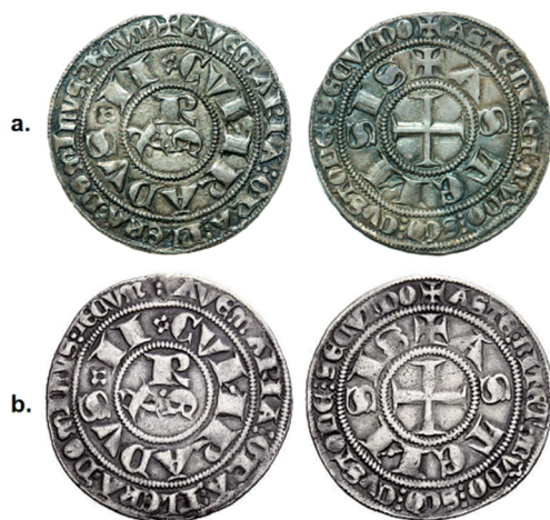
Fig. 3 - Confronto tra la moneta autentica (a) e il clone ottenuto per fusione a cera persa (b). 16
